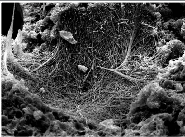
CALCESTRUZZO TRATTATO CON XYPEX
