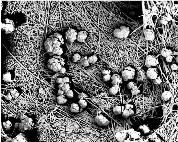
CALCESTRUZZO TRATTATO CON XYPEX ( 60% DI CEMENTO MISCELATO CON LOPPE )
