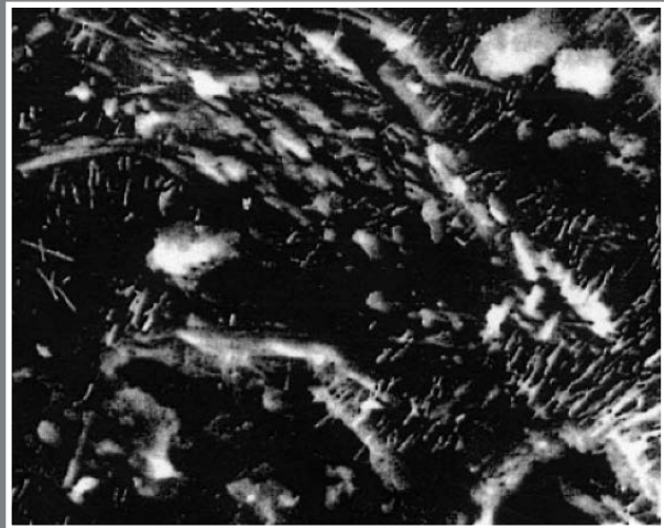
CALCESTRUZZO TRATTATO CON XYPEX
