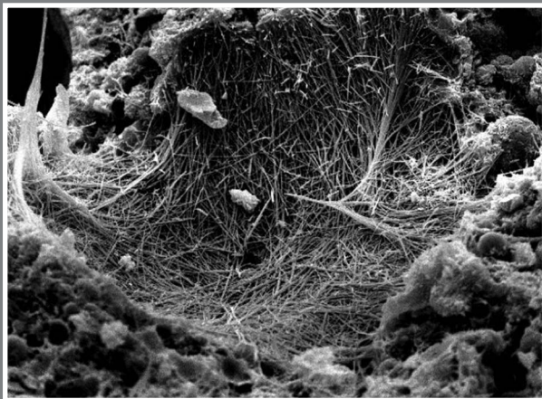
CALCESTRUZZO TRATTATO CON XYPEX
